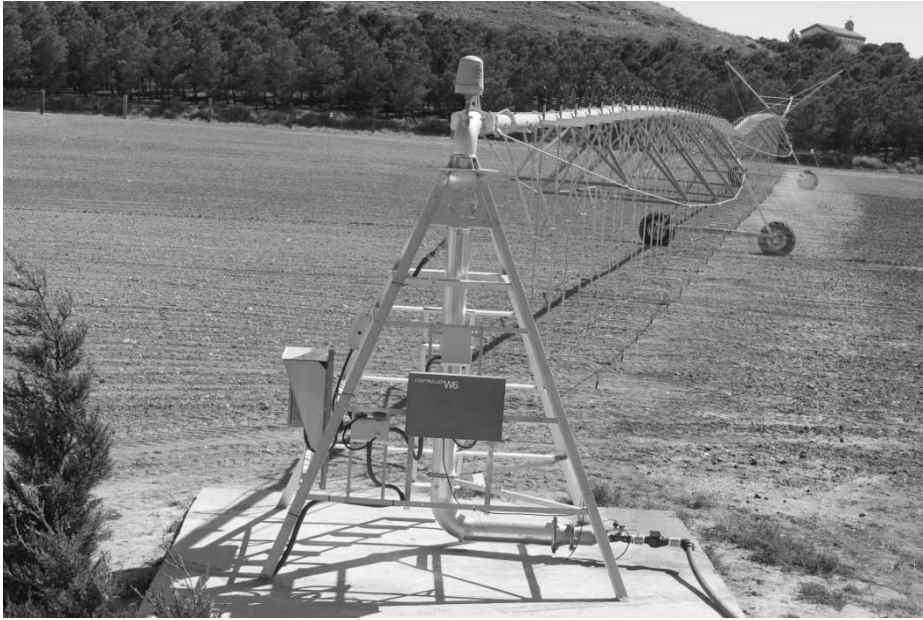
CENTER PIVOT SPRINKLER (PIVOT SIDE)
